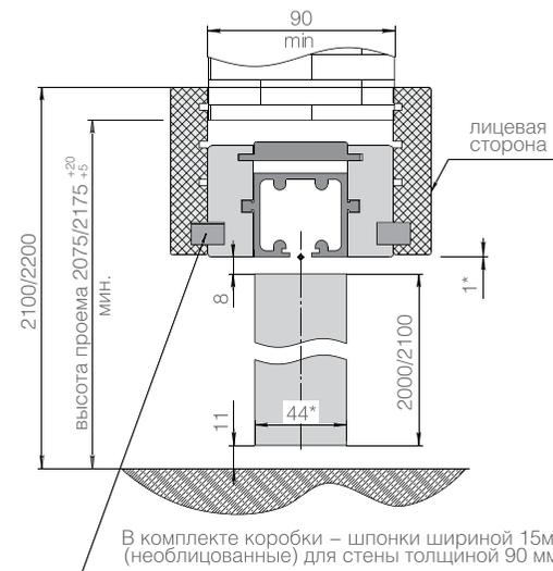
В комплекте коробки – шпонки шириной 15мм
